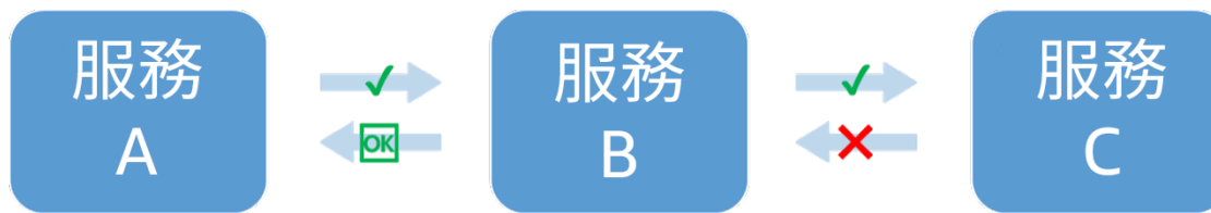
圖 5：從服務 B 呼叫服務 C 時失敗。服務 B 傳回降級回應給服務 A。
