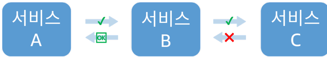
그림 5: 서비스 B가 서비스 C를 호출할 때 서비스 C에 장애가 발생하면 서비스 B는 성능이 저하된 응답을 서비스 A에 반환합니다.
