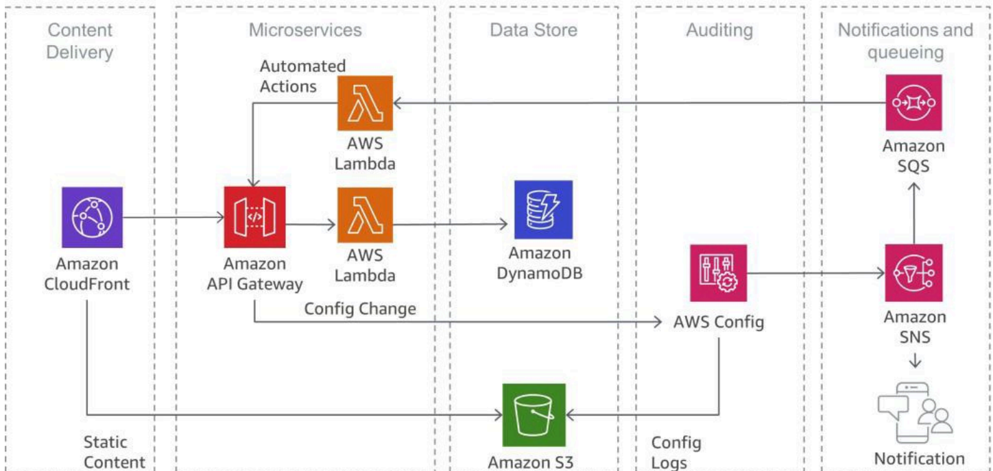
Abbildung 18: Erkennen von Sicherheitsverletzungen mit AWS Config
