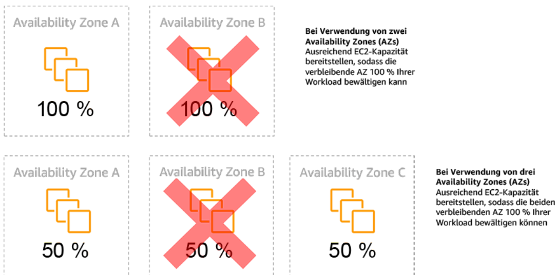
Abbildung 14: Statische Stabilität von EC2-Instances in Availability Zones
